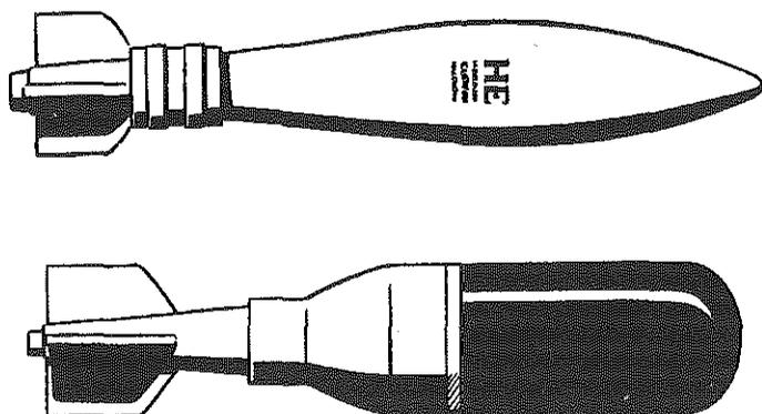
Le mortier M-12 accepte tous les types de projectiles indiqués ci-dessous. On les lâche dans le mortier, où l'allumage de leur fusée est déclenché par une épingle placée au fond du tube. Tous sont équipés d'ailerons stabilisateurs et ne s'arment qu'une fois sortis du tube.
